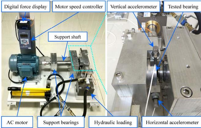
Fig. 4. XJTU-SY bearing test rig.
