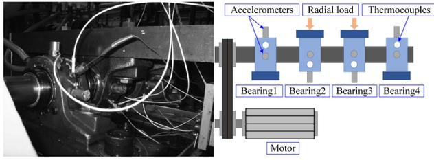
Fig. 3. IMS bearing test rig.
